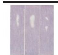
Nevyhovující výsledek – rezidua fibrinu ukazují na nedostatečné podmínky – krátká doba, nedostatečná teplota, chybějící chemikálie
