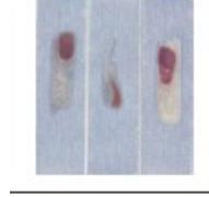
Nevyhovující výsledek – zůstávají jak bílkoviny, tak i fibrinová vrstva a je třeba prověřit všechny parametry, jak použitou chemii, tak i fyzikální parametry a tlak vody
