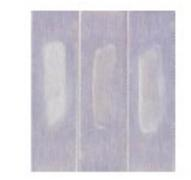
Nevyhovující výsledek – výrazná rezidua fibrinu mohou být způsobena špatným naskládáním vsázky nebo málo účinnou chemií, nízkou teplotou
